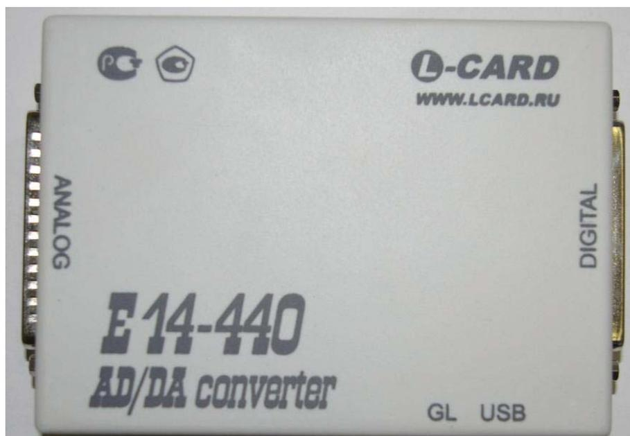
Рис. 1. Аналого-цифровой преобразователь (АЦП) E14-440
